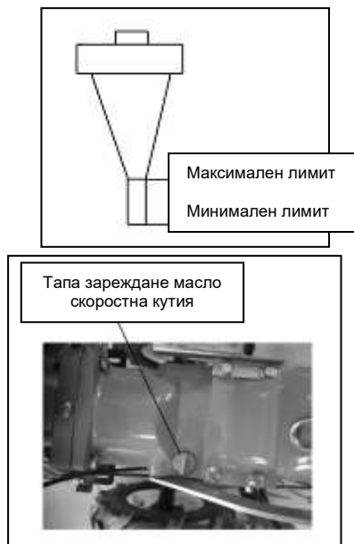
Фиг. 5 – Проверка на нивото на трансмисионното масло
