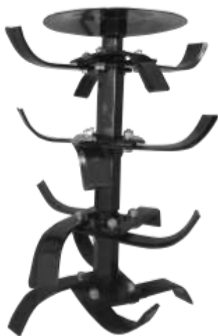
Sl. 3 – Sastavljanje rotacionih noževa freze
