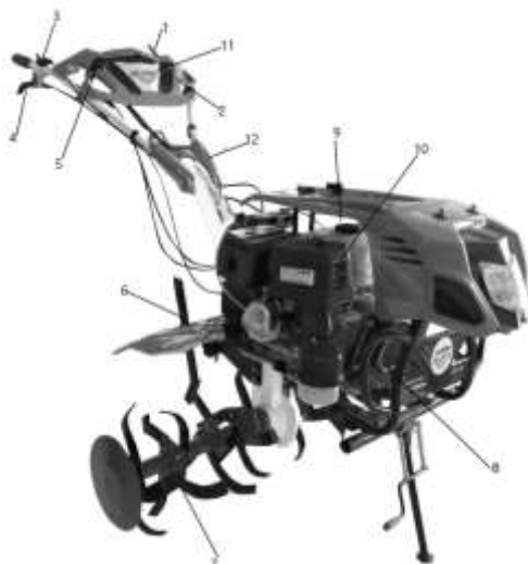
1. Ábra – A motoros kapálógép általános kinézete
